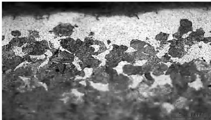
Рис. 3. Структура силицированной стали ШЧ15
